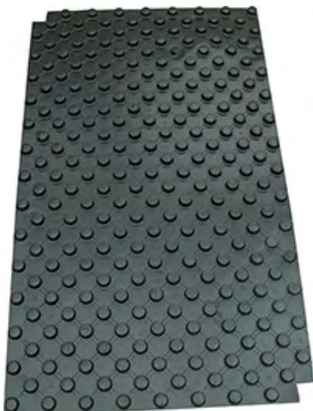
Pannello isolante preformato R979B per pavimenti radianti. Realizzato in polistirene espanso sinterizzato (EPS150) con strato di protezione in polistirene termoformato nero.
